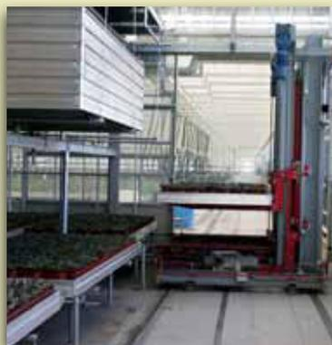
Robot per la movimentazione dei bancali vuoti da sottoporre a disinfezione
