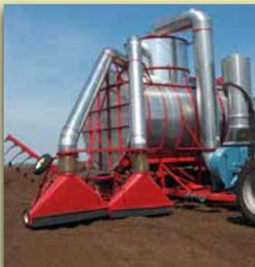
La raccolta per aspirazione della torba raccolta con fresatura
