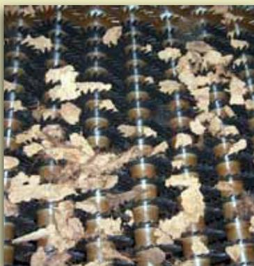
Il sistema rotante per la macinatura e vagliatura delle torbe grossolane
